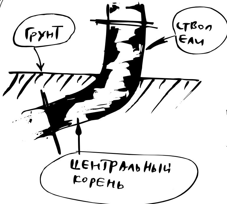
ШПАНГОУТЫ ВЫРУБАЮТСЯ ИЗ СТВОЛА ЕАИ В МЕСТЕ ЕЕ СОЕДИНЕНИЯ С КОРНЕМ. ЭТОТ БРУСОК РАСПИЛЫВАЕТСЯ ИЛИ РАСКЛАНЫВАЕТСЯ ТОРОРОМ ШПАНГОУТА. -ДОЛБЛЕНКУ НА ДВА ЧАСТИ. НА ЛОДКУ НУЖНО ЧЕМУ ШПАНГОУТЫ.
